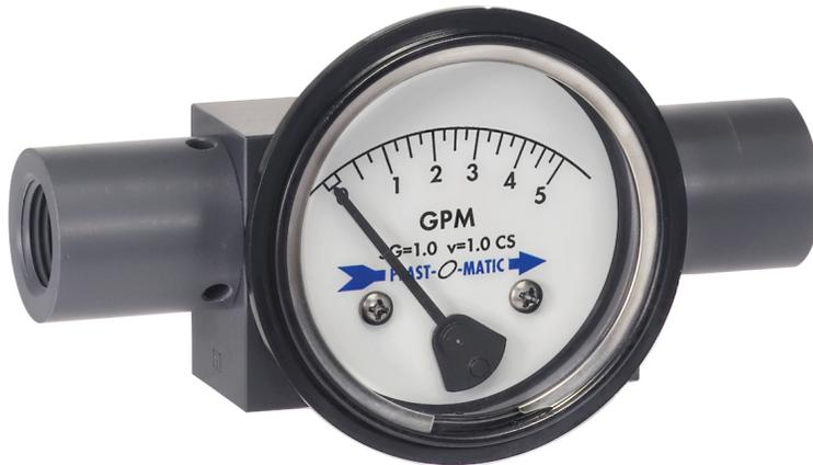
Los medidores de flujo Plast-O-Matic indican los caudales de flujo de líquido desde flujos bajos de GPM de 0-1 a GPM de 0-10, incluso cuando se utilizan en altas presiones de línea. Los sensores del indicador de flujo pueden suministrarse con interruptores o relés para iniciar alarmas, activar otros equipos o apagar el sistema. Se utilizan dos interruptores cuando se desean límites altos y bajos. La clasificación de la presión máxima de línea es 200 PSI.
