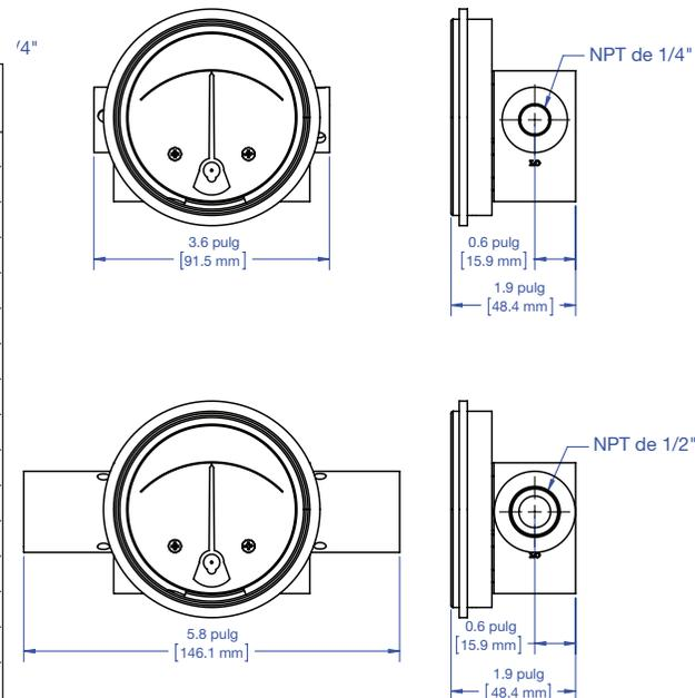
**Notas - Materiales del cuerpo y la junta:** Todos los números de las piezas que se muestran tienen cuerpos de PVC con juntas FKM (Viton). Para cuerpos de CPVC, cambie "-PV" a "-CP". Para juntas de EPDM, cambie primero "V" a "EP". Por ejemplo, FIG025V se convierte en FIG025EP.
