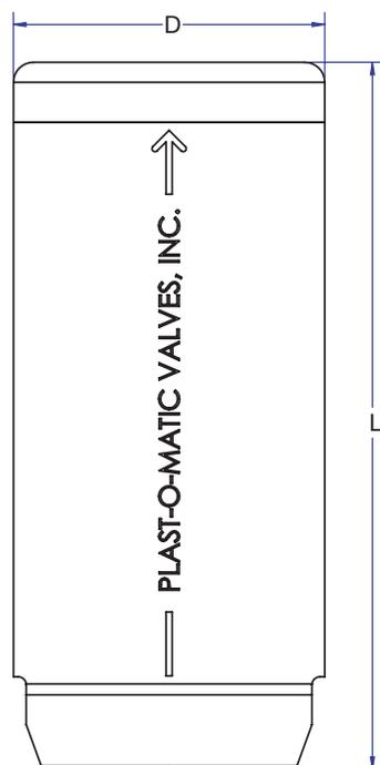
Si se produce un quiebre en la tubería y causa una pérdida repentina de líquido, podría formarse un vacío en la tubería y hacer que colapse o sifone de manera indeseada. En ese caso, el cuerpo de la válvula CARD vaciará el líquido, el flotador caerá permitiendo que se abra el orificio grande, que, a su vez, permite el ingreso de aire atmosférico en la tubería y evita la formación del vacío. Este es el modo de la VÁLVULA DE CONTRAFLUJO.
